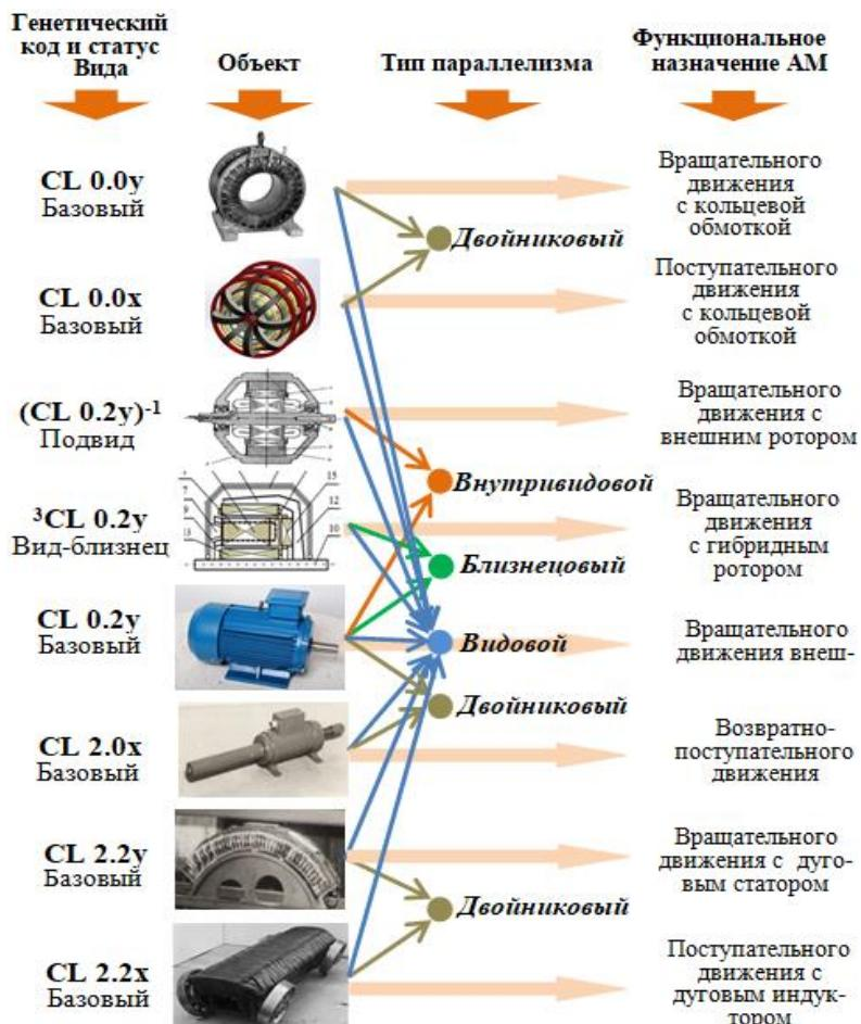
Рисунок 10 – Структурные представители внутриродовых параллельных рядов, выявленные в ходе эволюционных экспериментов (на примере эволюции Рода цилиндрических асинхронных машин)
