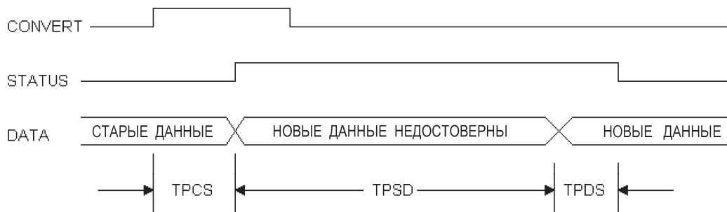
Рис. 13.14. Временные диаграммы работы АЦП
