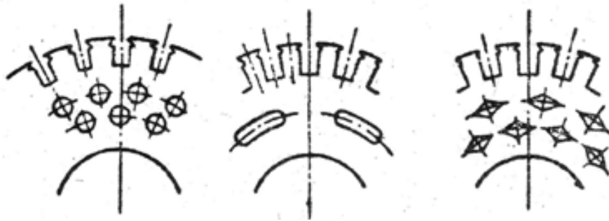
Рис. 6.13. - Шихтовка листів ротора
